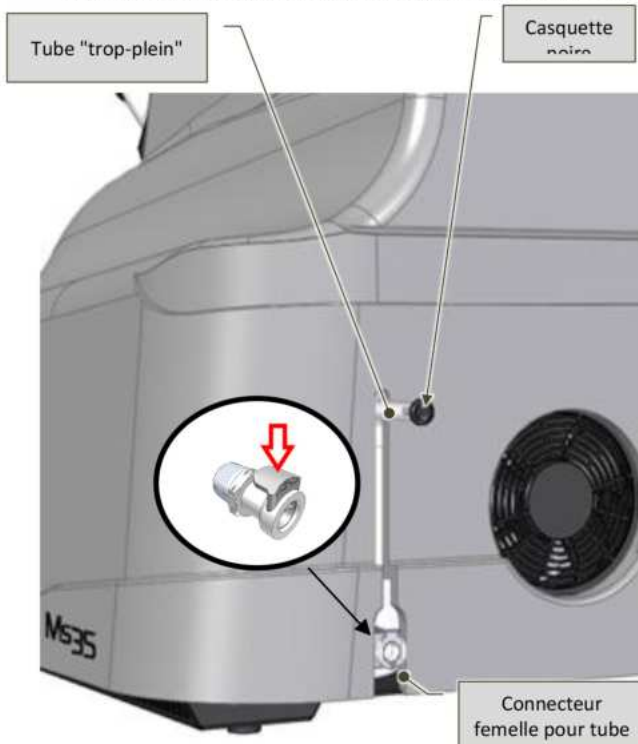
Figure.7-18– Appoint de liquide de refroidissement – vue arrière de la machine
